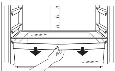
Ящик FreshZone предназначен для хранения таких свежих продуктов, как мясо, рыба, морепродукты, поскольку температура в нем ниже, чем в остальной части холодильника.
